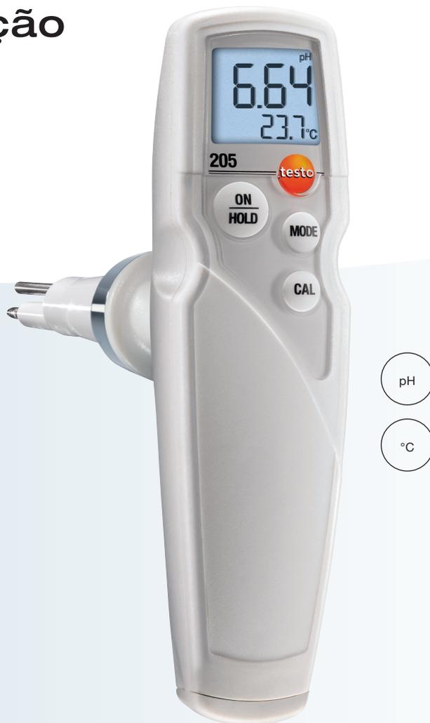
O testo 205 é um instrumento robusto de medição de penetração de alimentos para valores de temperatura e pH, com compensação automática de temperatura. A ponta de medição de penetração robusta é substituível e resistente à sujeira graças ao diafragma do furo.
